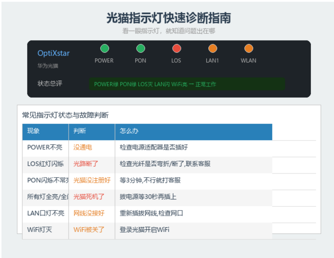
图1-1: 光猫指示灯快速诊断指南（记住：PON绿=正常，LOS红=光路故障）
